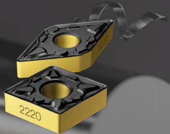
Con una excelente resistencia a la deformación plástica, GC2220 es una calidad específica para torneado y está optimizada para mecanizado de acero inoxidable en condiciones estables. El recubrimiento Inveio™ otorga a la calidad GC2220 un mayor nivel de resistencia al desgaste y vida útil de la herramienta para superar retos tales como altas fuerzas de corte y temperaturas.
