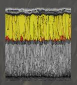
Con Inveio®, cada cristal del recubrimiento de alúmina está alineado en la misma dirección, lo que crea una resistente barrera en la zona de corte.
