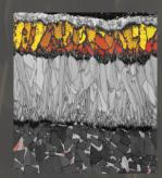
Recubrimiento de alúmina de CVD convencional con orientación aleatoria del cristal.
