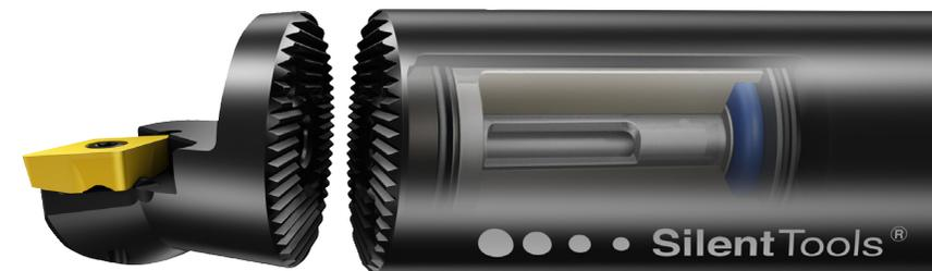
En el interior de la herramienta antivibratoria se encuentra un sistema antivibratorio pre-amortiguado compuesto de una masa pesada soportada por resortes de caucho. Además, se añade aceite para aumentar la amortiguación.
